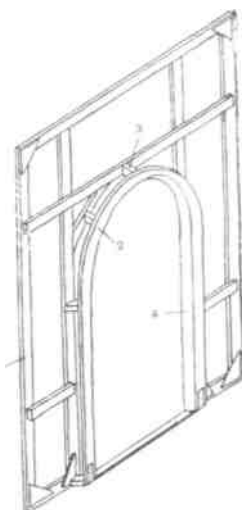
Рис. 68. Арка с толщиной: 1 — рама стенки; 2 — лекало; 3 — распорный брусок; 4 — коробка; 5 — порог
